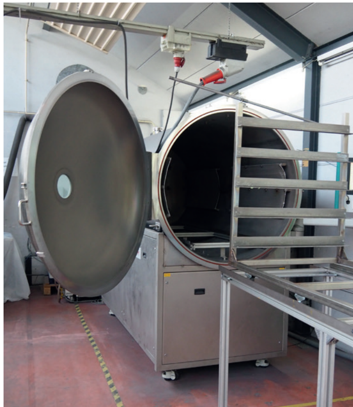
Für die Vorbehandlung verfügt Dicoma neben einer Trockeneisanlage auch über eine Plasmaanlage.
